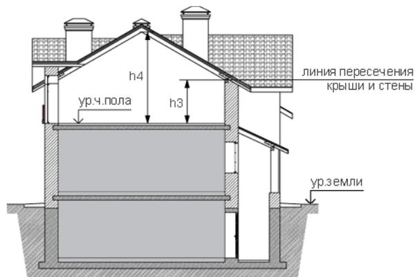
**Рис. 1. Определение мансардного этажа ( $h_3 < 1.5$  м.)**
