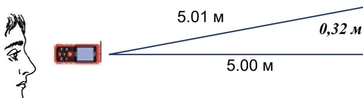
**Рис. 12. Определение высоты кривизны лазерного луча**
