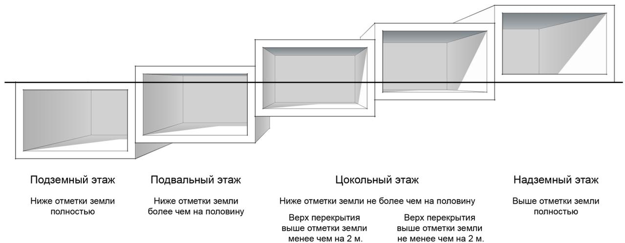
**Рис. 5. Сравнение подземного, подвального, цокольного и надземного этажа<sup>3</sup>**
