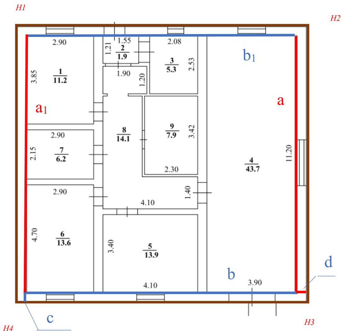
**Рис. 15. Линейные измерения для расчета СКП площади здания**
