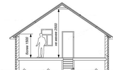
**Рис. 2. Определение надземного этажа, не являющегося мансардным**
