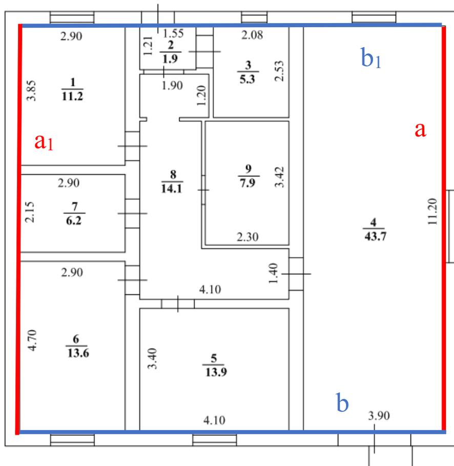
**Рис. 14. Линейные измерения для расчета СКП площади здания**
